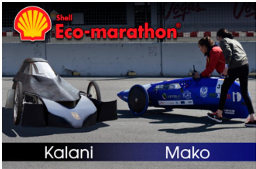
alcanza una velocidad de 45 km/h y cuenta con chasis de aluminio con una carrocería de fibra de vidrio, todo manufacturado por ellos.
